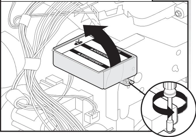
Utiliser un tourne-écrou hexagonal de 1/4" ou un tournevis Phillips; démonter le couvercle du boîtier de connexion; conserver la vis et le couvercle pour réutilisation.
